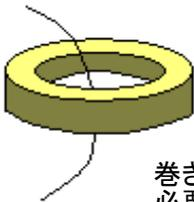
巻き数の数え方は、左図のようにコアーの真ん中の穴を通した時を、1回と数えます。必要数をコアーの回りに、なるべく均一になるように巻きます。巻き初めと、巻き終わり の線は、同じ場所でクロスします。線はクロスしても、しなくてもOKです。
