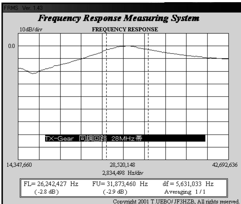
注:高いバンドでは、Qがかなり低くなります。そのためアンプとしてのゲインが、あまり取れない場合があります。そのようなときは、トロイダルコアを使用してコイルを製作してみてください。コイルのQが高くなり、ゲインが上がり選択性も良くなります。 CYTEC
