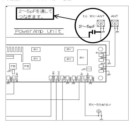
図の様に、2~5pFを通して MIX&VFOユニットの、CALーO UT端子からの、リード線を 受信機アンテナコネクターへ、直 接つなぎます。
