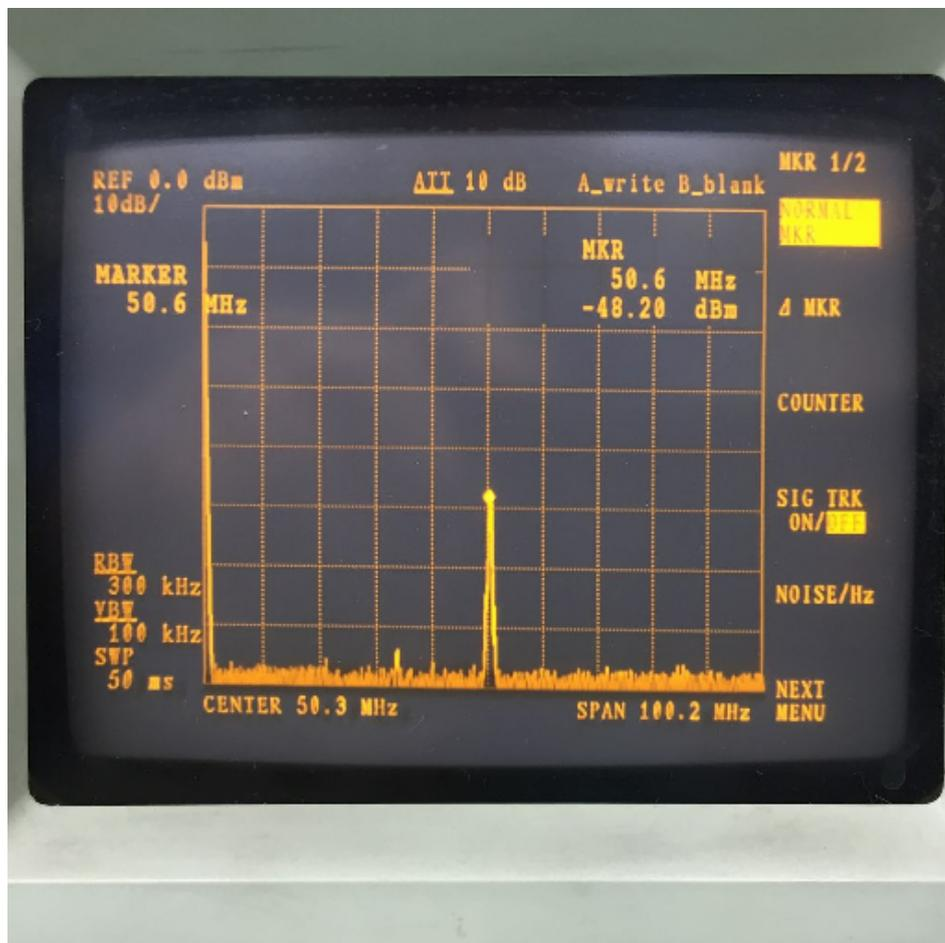
2SC2053 のアイドル電流を少し下げて 35mA とし、出力部で計測すると以前はキャリアサプレッションが 25dBm 程でしたが改善後は 31dBm 以上となり、出力は 22dBm (約 160mW) となりました。
