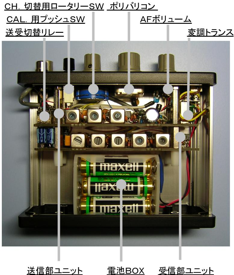
●プリント基板(生板)に部品を直付け(GND部)し信号線は空中配線にて組上げていきました。
